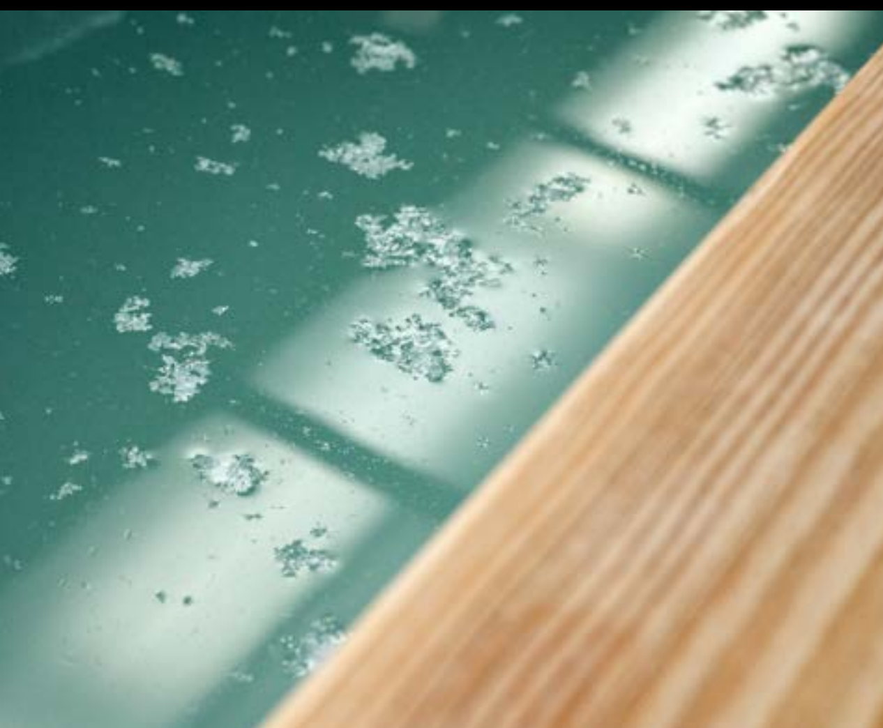
In der grossen Verdampfungswanne bilden sich bei 55 °C feine Salzkristalle an der Oberfläche – die begehrten „Salzblumen“.
