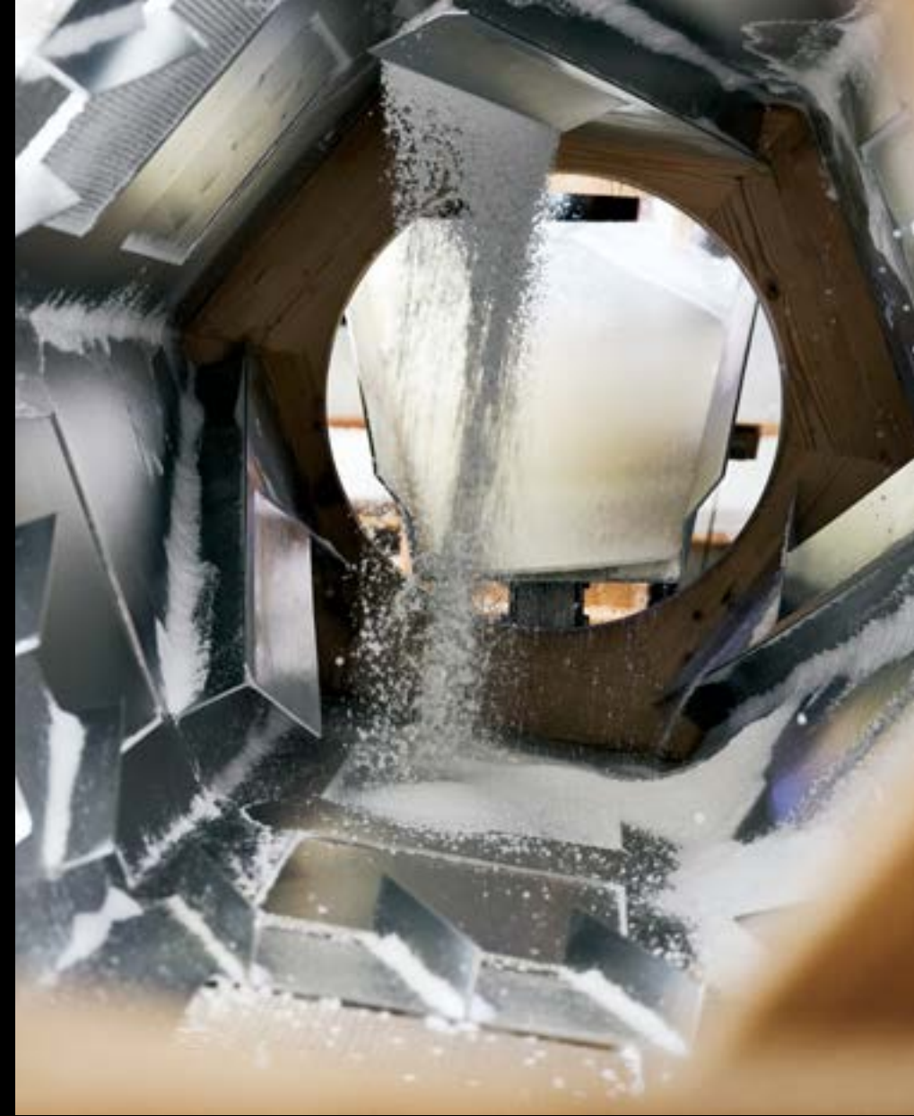
Während die Trommel langsam rotiert, trocknen die über Nacht gereiften Salzkristalle im 100 °C warmen Vertikaltrichter schonend, sodass ihre grobe, natürliche Struktur erhalten bleibt.
