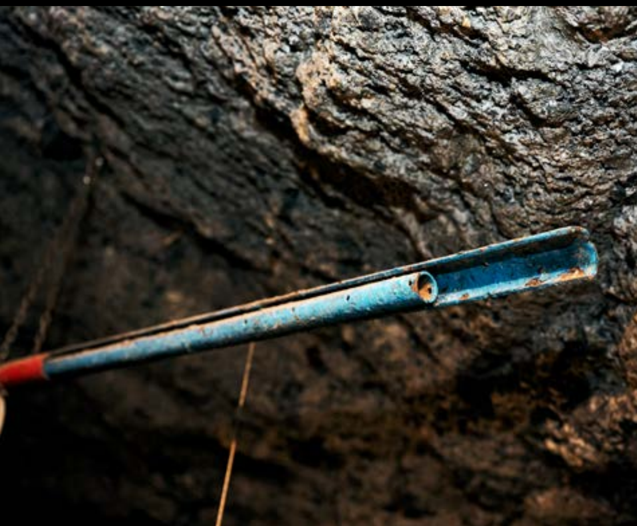
Das clevere Zwei-Rohr-System: Durch das innere Rohr fließt Frischwasser ins Gestein, durch das äussere wird die konzentrierte Sole unter Druck zurückgeleitet.
